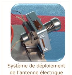
Système de déploiement de l'antenne électrique
